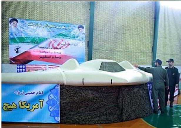
Présentation du RQ-170 Sentinel intact par l'Iran. La grille qu'on aperçoit est l'entrée du réacteur, situé au milieu de "l'aile volante", conçue pour éviter "l'ingestion d'oiseaux".
