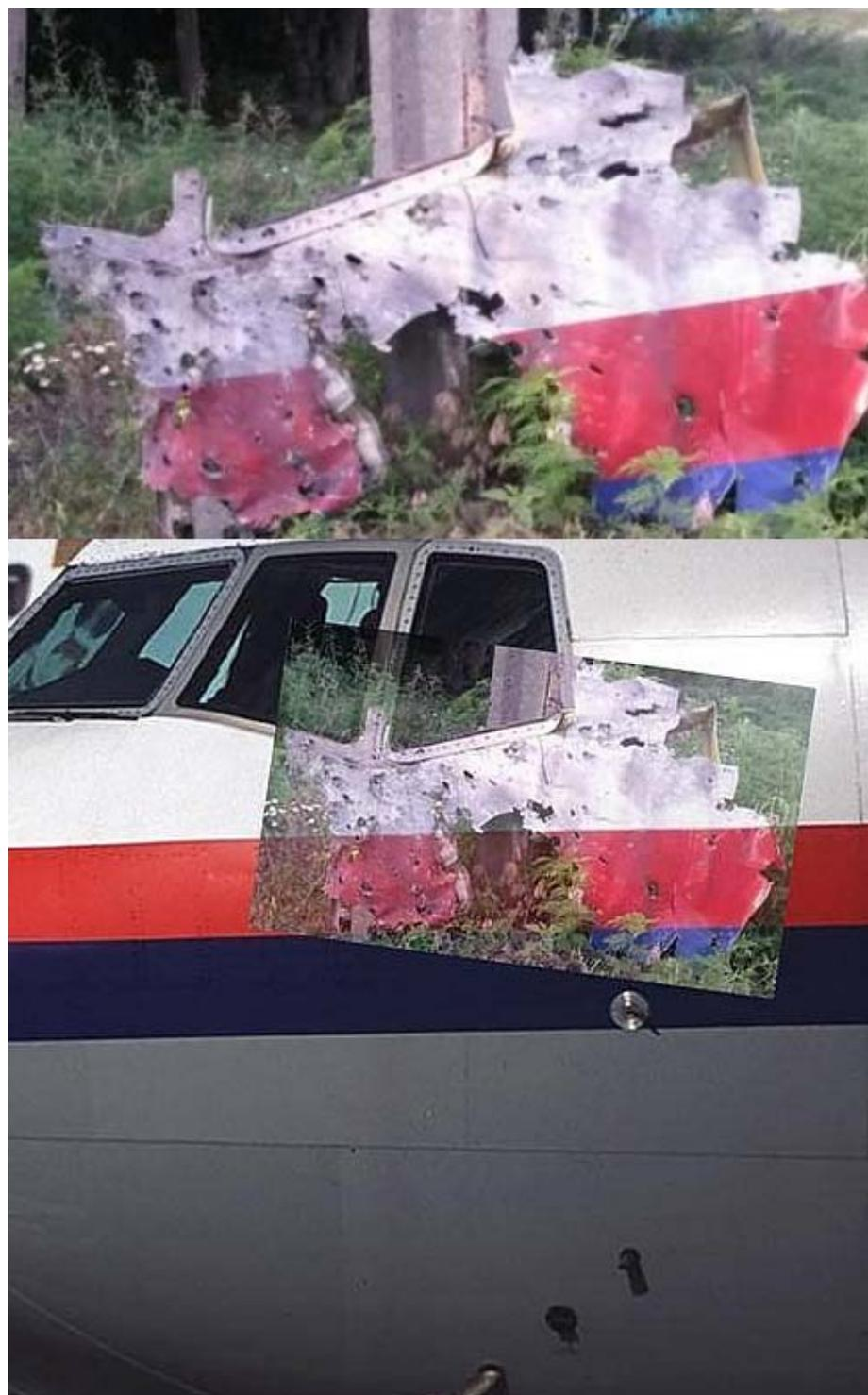
Les impacts dans le panneau du fuselage du côté droit du cockpit du vol MH-17 ont été produits par un projectile de type explosif-incendiaire visant à produire des foyers d'incendie à l'intérieur de la cabine. De petits éléments des cadres de pare-brise en alliage d'aluminium étaient fondus en raison de l'incendie.
