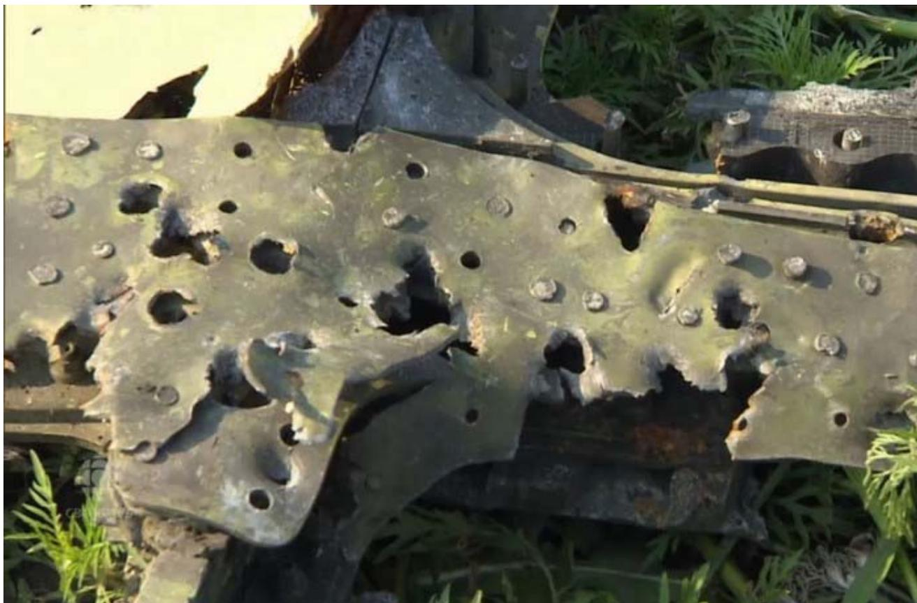
Les tirs ont été effectués par un pilote de chasse expérimenté, qui a visé uniquement la cabine de pilotage. Cela est démontré par le fait que la section de fuselage à l'arrière du poste de pilotage est restée intacte et ne comporte pas de trous qui auraient pu être causés par des éclats de projectiles.
