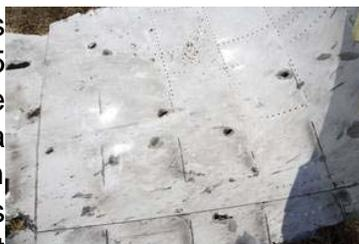
Le guidage radar d'un missile sol-air SA-11 l'aurait amené à exploser à environ 20 m sous la zone de plus grande résonance radar, c'est-à-dire la partie centrale incluant les ailes. Mais alors que la cabine est effectivement criblée de projectiles, les photos des débris montrent des parties entières de fuselage entre la cabine et les ailes sans aucun trou. Il est impossible que les projectiles n'aient pas atteint cette partie.
