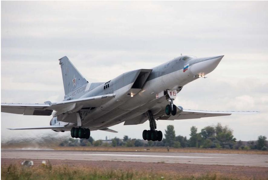
L'avion a un rayon d'action de 4.000 km et porte 24 tonnes de bombes ou raquettes. Tu-22M3 peut être armé de 10 raquettes de croisière : 6 x Kh-15 (vitesse Mach 5, visée 250 km) dans le lanceur rotatif caréné à l'intérieur du fuselage, et 4 x Kh-22/27 (vitesse Mach 4, visée 500 km) ou bien Kh-55 (visée 2.000 km) sous le fuselage ou sur les pilonnages des ailes. Le dispositif russe de défense de la péninsule de la Crimée inclura à partir de 2015 des raquettes Iskander-M (rayon d'action 500 km).
