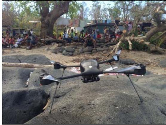
**3- Indago VTOL Quad Rotor (produit par Lockheed Martin) avec décollage et atterrissage verticaux.**
